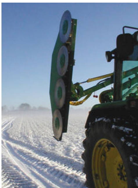
Abb.98: Lichtprofilsäge mit 4 Kreissägeblättern (Foto: SCHAPER)
