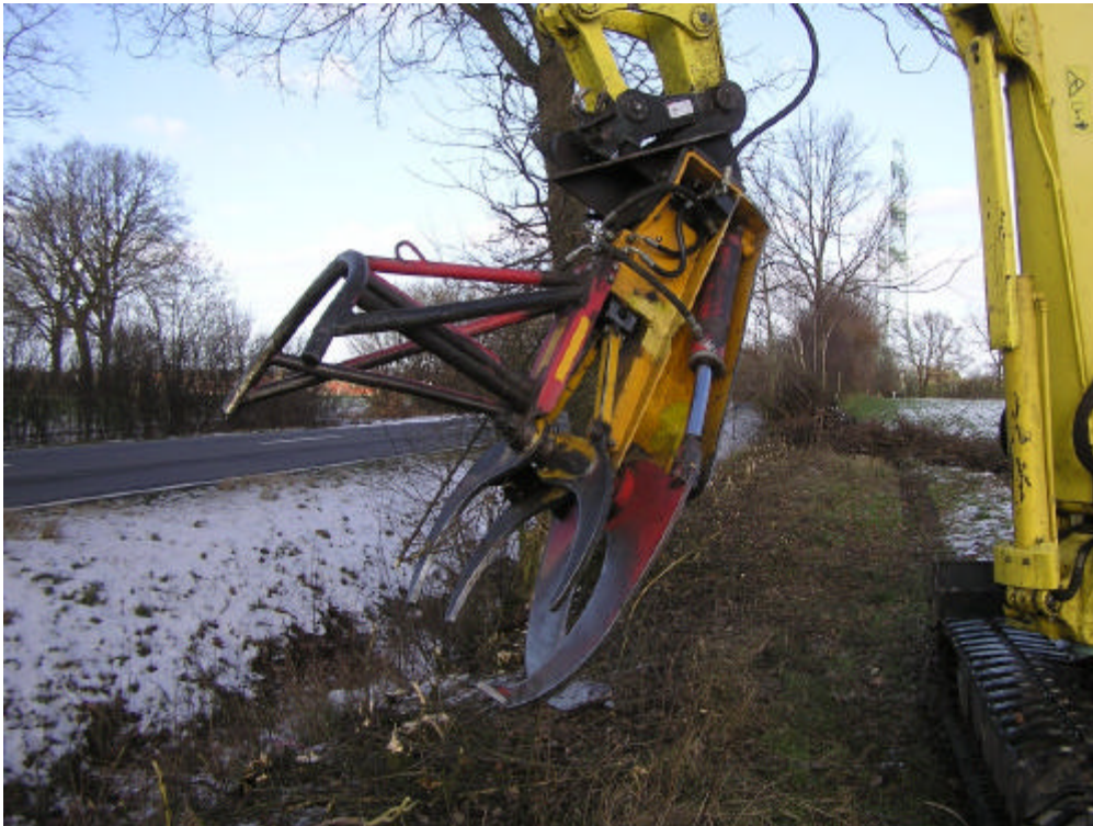
Abb.97: Knickschere am Raupenbagger (Foto: MÜLLERCHEN)
