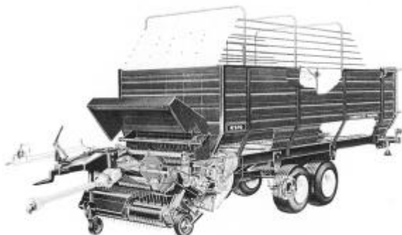
Abb.89: Kurzschnittladewagen zur Aufnahme und Häckselung des Mähgutes (KUNZE 1986, 115)
