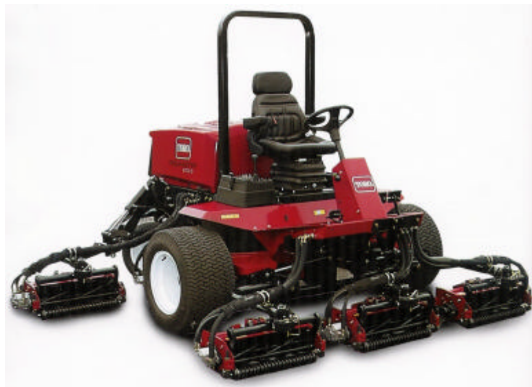
Abb.59: Spindelmäher der Firma TORO für Golfplätze, Schnittleistung von 3,7 ha/h (Herstellerfoto)
