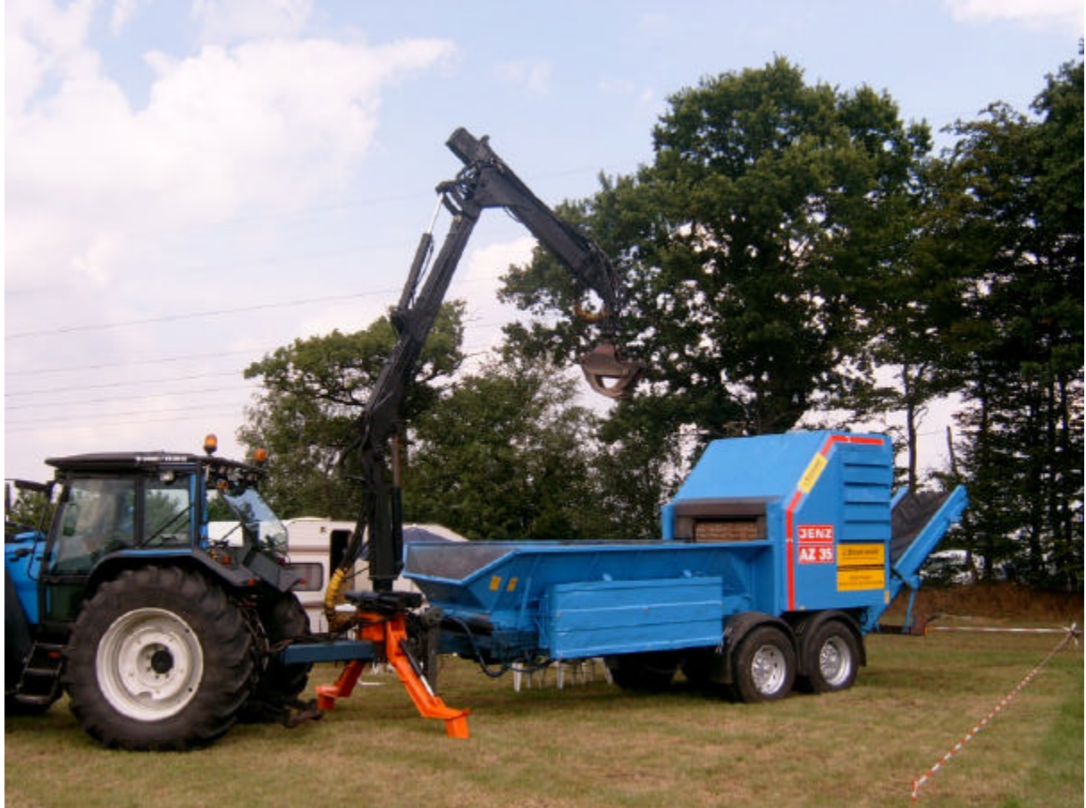
Abb.103: Großer Schredder der Firma JENZ mit Greifarm und Förderband (eigenes Foto)
