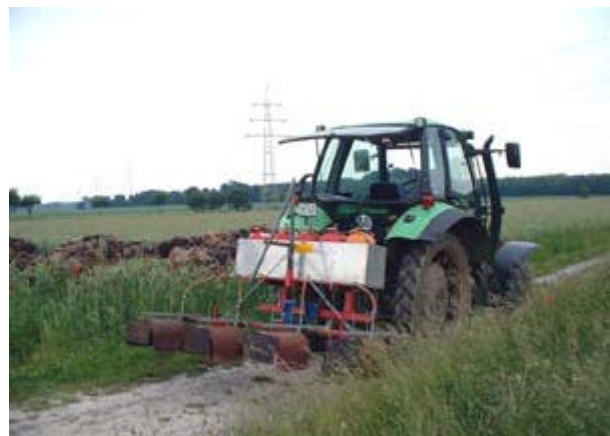
Abb.55: Großes Abflammgerät am Schlepper (OEKOLANDBAU, online)
