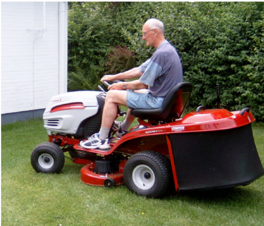
Abb.67: Rasentraktor mit Mulchkitt und der Möglichkeit des Heckauswurfs (eigenes Foto)
