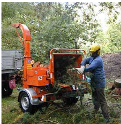
Abb.102: Kleiner Schredder auf Hänger montiert (Foto: KUTH & WOHLBERG GBR)
