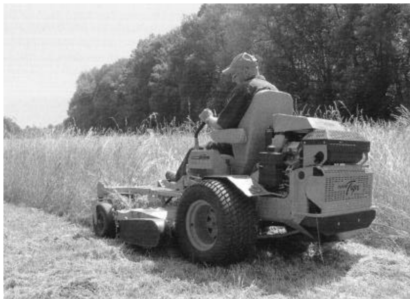
Abb.66: Aufsitz-Allesmäher mit frei gelagerten Fronträder (NIESEL 2002, 212)
