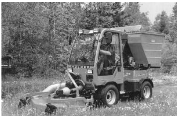
Abb.80: Multifunktionsgeräteträger mit Mäh-Saug-Kombination (NIESEL 2006, 213)
