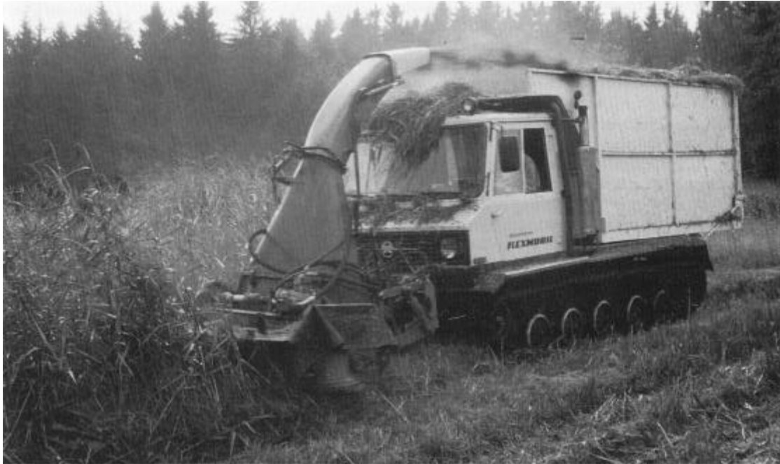
Abb.82: Raupenfahrzeug mit Scheibenmähwerk, 2,4 m Arbeitsbreite und 10 m 3 Aufbaukipptainer (JEDICKE 1996, 215)
