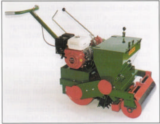
Abb.31: Rasenbaumaschine mit Glattwalze und Igelwalze (LOMER 2001, 433)
