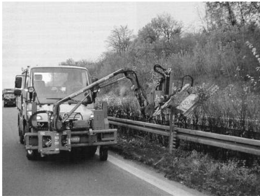
Abb.92: Messerbalken am Unimog bei der Autobahnpflege (JEDICKE 1996, 234)
