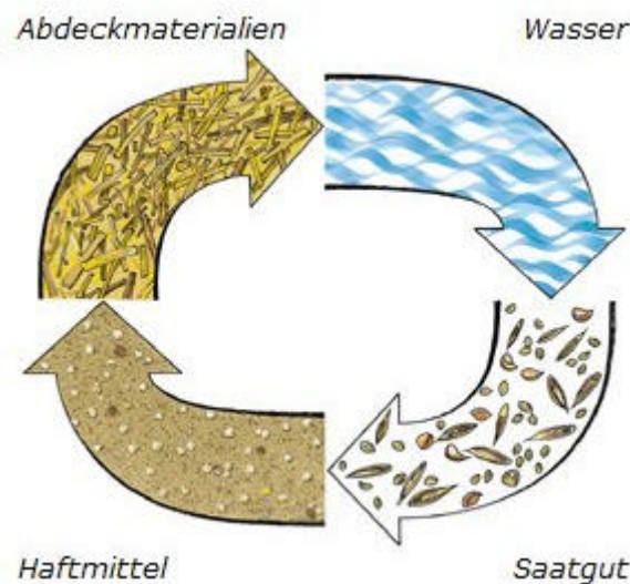
Abb.44: Zusammensetzung einer Hydrosaat (VERDYOL INTERNATIONAL AG, online)
