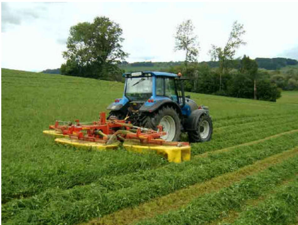
Abb.75: Dreiteiliges Trommelmähwerk, gemäht wird in Rückfahrrichtung (GERBER, online)
