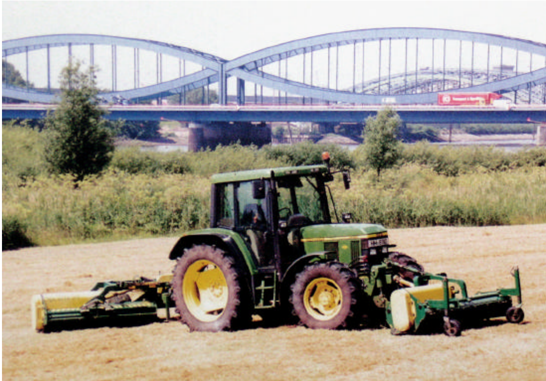
Abb.71: Schlegelmäher am Schlepper, eingesetzt in der Stadt Hamburg (GERBER 2005, 9)
