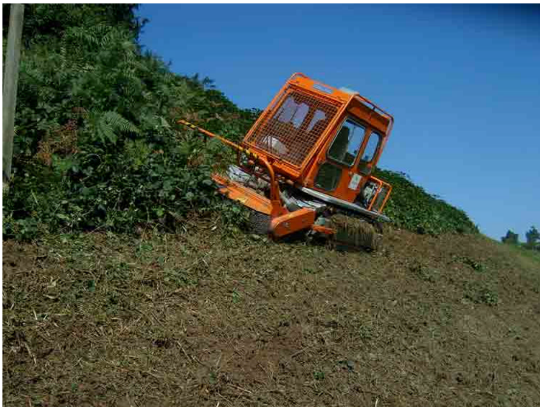
Abb.72: Raupenfahrzeug mit Schlegelmähwerk beim Mulchen von Dorngestrüpp (GERBER, online)
