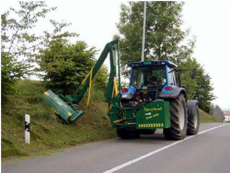
Abb.70: Schlegelmäher am Auslegergrundgerät beim Böschungsmähen (EGGER, online)
