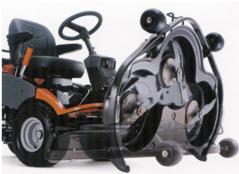
Abb.61: Frontmäher mit drei Messern (Herstellerfoto Firma HUSQVARNA)
