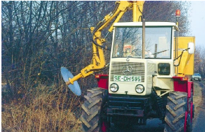
Abb.99: Kreissägeblatt am Schlepper (Foto: BRETSCHNEIDER)
