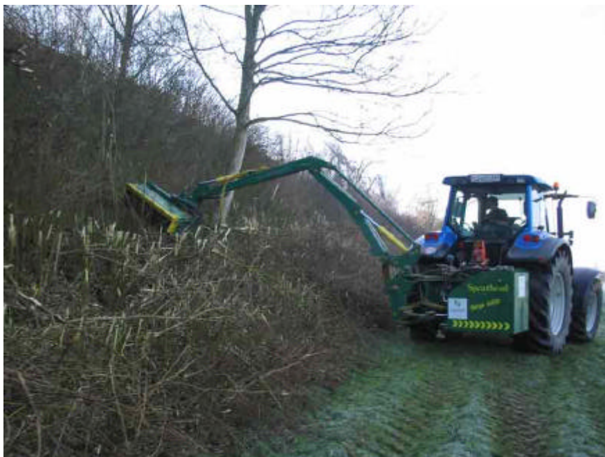
Abb.100: Schlegelmäher am Auslegergrundgerät bei der Gehölzpflege (GERBER, online)
