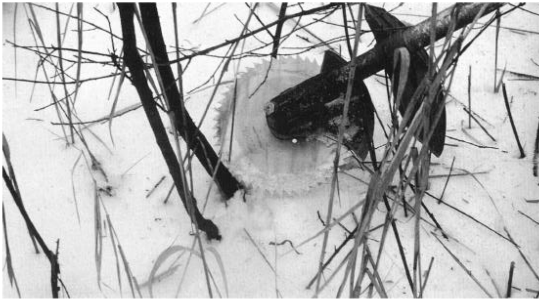
Abb.96: Freischneider mit Sägeblatt (JEDICKE 1996, 233)
